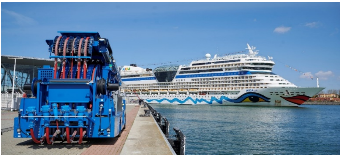
Abbildung 4-2: Übergabewagen der Landstromanlage am Liegeplatz P8 in Warnemünde
